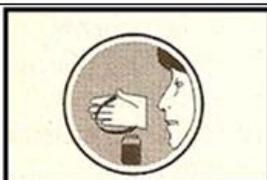
Проверка прибора на герметичность при получении газообразных веществ. (Почему газоотводная трубка повернута вверх?)
